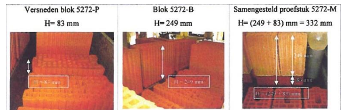
Fig. 3: Wateropslorping door capillariteit opversneden blokken, blokken en samengestelde proefstukken
